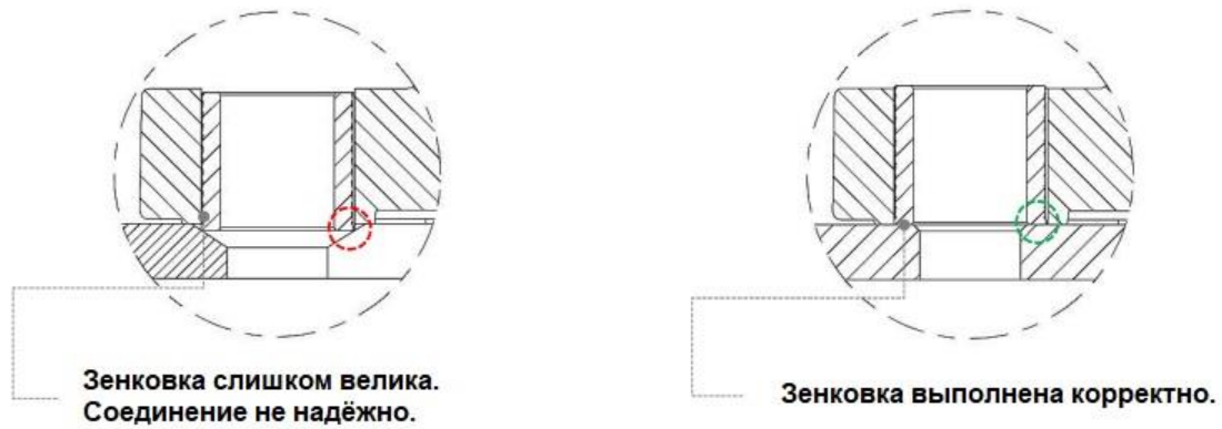
Рис. 2 Рекомендуемый диаметр зенковки
