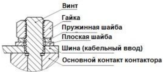
Рис. 1 Схема подключения шины
