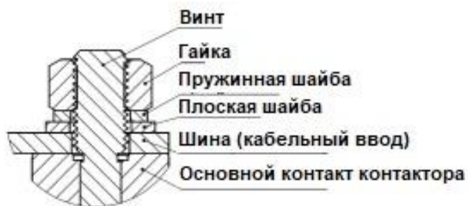
Рис. 1 Схема подключения шины
