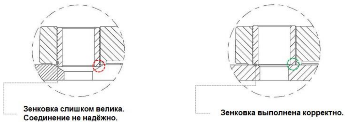
Рис. 2 Рекомендуемый диаметр зенковки
