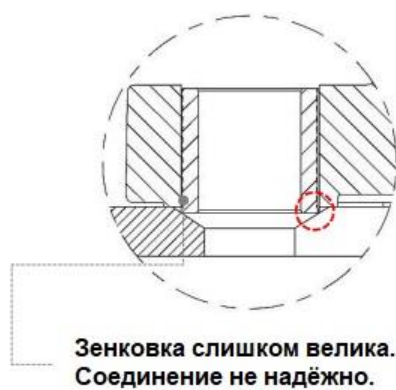
Рис. 2 Рекомендуемый диаметр зенковки
